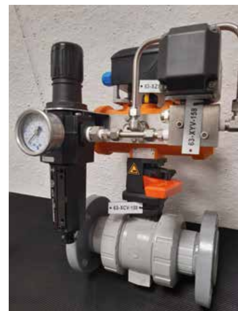
VALVOLE A SFERA DN50 IN PVC-C PNEUMATICHE EQUIPAGGIATE DI BOX FINECORS, SOLENOIDE E FILTRO REGOLATORE COLLEGATI TRAMITE TUBING IN ACCIAIO INOSSIDABILE.
