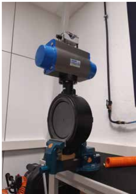
VALVOLA A FARFALLA DN250 CON ATTUATORE PNEUMATICO R&P CON BOX FINECORSA
