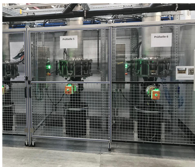
A garanzia dei massimi standard qualitativi, le valvole a farfalla vengono testate in un banco di prova nelle condizioni più severe.
