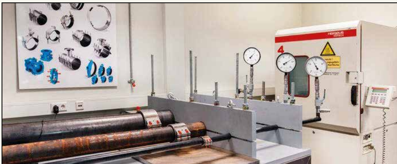
UNI-koblingen gennemgår meget hårde tætheds- og trækfasthedsprøvninger.
