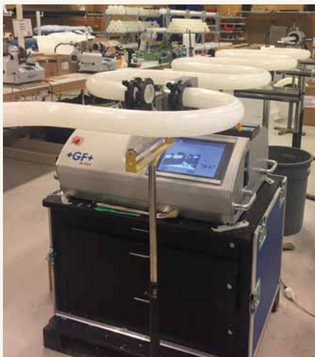
Bukkede PVDF emner bliver IR svejst. Svejse/køletid pr. samling for d63 er mellem 4 og 9 minutter afhængig af omgivelsestemperatur. Svejst på den nye IR-110 A.
