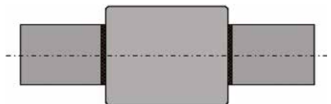
Schweißfehler außen – Ungenügendes Schälen
