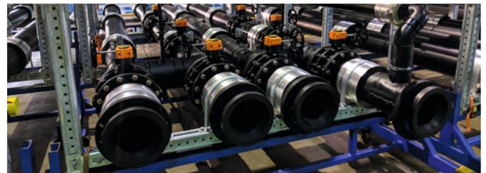
Los módulos de tuberías prefabricadas están preparados para su envío al lugar de instalación.
