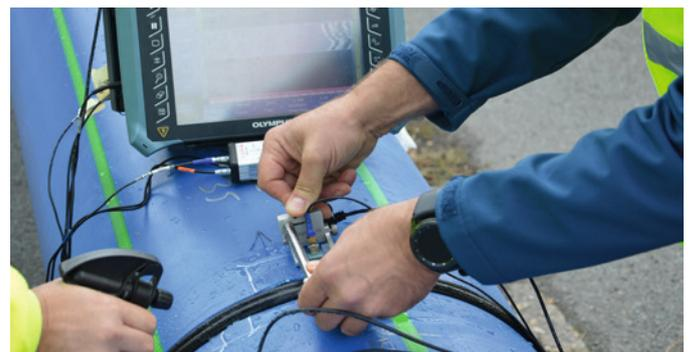
Zerstörungsfreie Ultraschall (NDT) Prüfung der d500 mm Stumpfschweißverbindungen im HDD-Durchgang.
