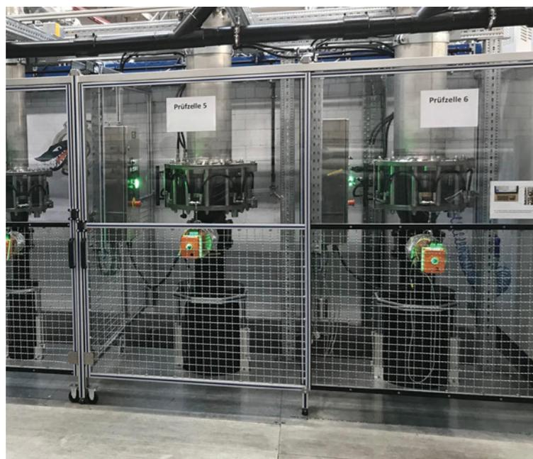
Pour garantir un standard de qualité élevé, les vannes papillon sont testées dans les conditions les plus difficiles sur un banc d'essai.
