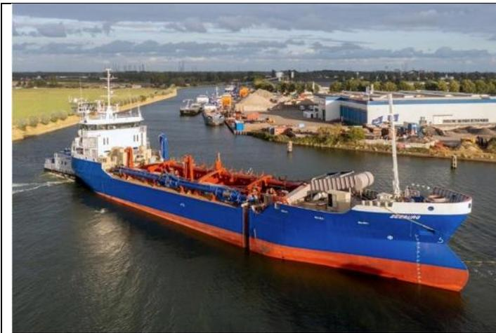
Die ecoFIT Rohre aus HDPE an Bord der MS Zeeburg sind Teil der Baggervorrichtung und kommen bei der Wasserinjektion zum Einsatz.
