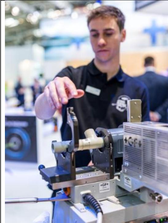
Auf der Messe in Frankfurt können Besucher die neu vorgestellte IR-63 M Schweissmaschine erleben. Sie kombiniert die zuverlässige Infrarot-Schweisstechnik mit den neuesten Technologien für mehr Präzision und Effizienz.
