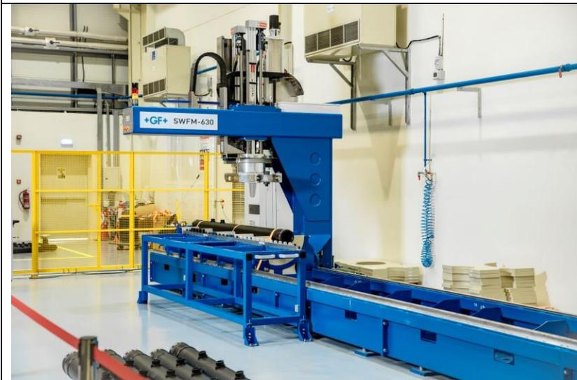
Im Zuge der aktuellen Standorterweiterung kann GF Corys nun mit Hilfe der SWFM-630 Schweißmaschine von GF Piping Systems kritische Rohrleitungskomponenten vor Ort fertigen.
