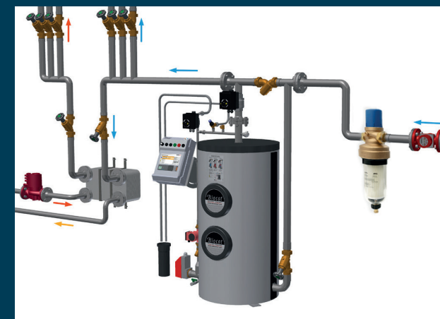
Représentation schématique d'une installation d'eau potable avec BIOCAT 14000
