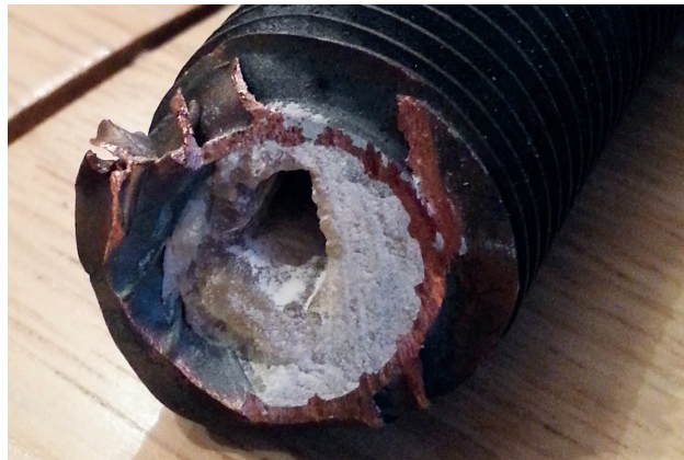
Échangeur de chaleur à tubes à ailettes en cuivre entartré provenant d'un réservoir tampon
