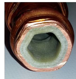
Tube en cuivre présentant une couche de calcaire
