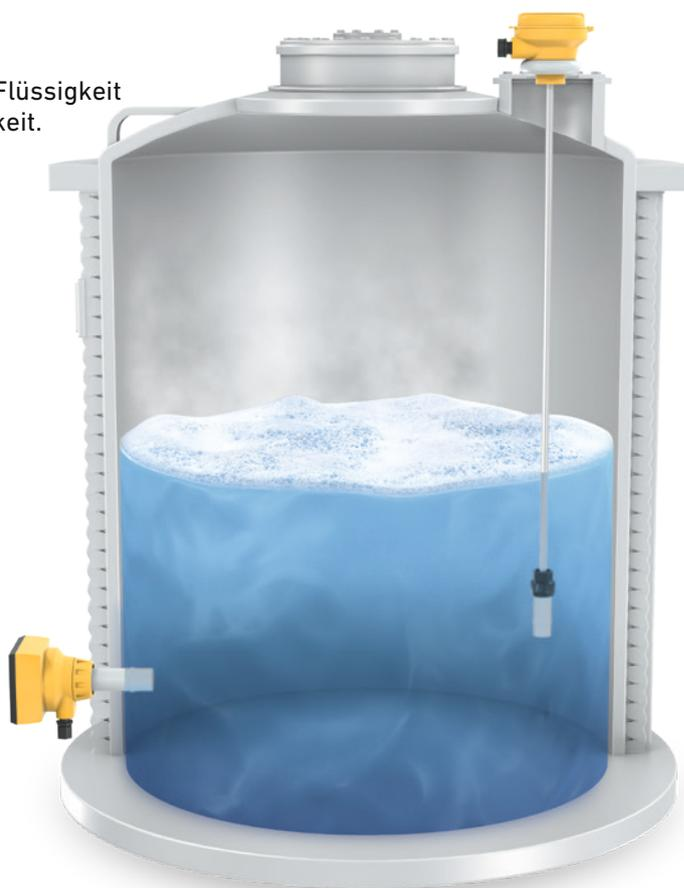
An der Tankwand montiert oder von oben in den Tank getaucht – ein hydrostatischer Sensor misst das Gewicht einer Wassersäule. Die Änderung des Drucks auf den Sensor ist proportional zur Änderung des Füllstands im Tank. Eine Kapillare im Kabel gewährleistet, dass Änderungen des atmosphärischen Drucks kompensiert werden können.
