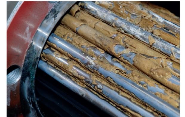
Rohrbündelübertrager mit Kalkablagerungen
