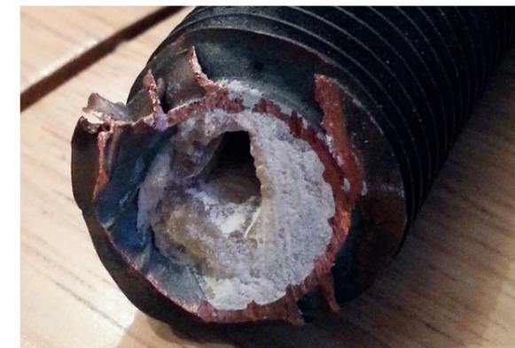
Verkalkter Kupfer-Rippenrohr-Wärmetauscher aus einem Pufferspeicher
