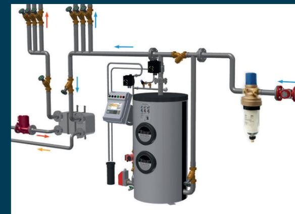
Schematische Darstellung einer Trinkwasser-Installation mit BIOCAT 14000
