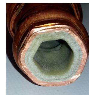
Kupferrohr mit Kalkschicht
