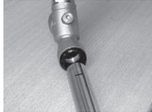
4 Gehäuse vor dem Einstecken des Rohres auf Sauberkeit und korrekten Sitz des O-Rings optisch überprüfen. Rohr unter leichtem drehen bis zur Markierung einstecken.
