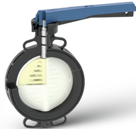
Abbildung 3: Das geringe Gewicht der 565 ergibt sich durch ein Gehäuse aus faserverstärktem Polyamid und eine Ventilscheibe aus Polyvinylidendifluorid.
