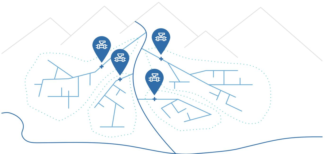
Druckmanagement gilt als die nützlichste, wichtigste und günstigste Managementaktivität gegen Leckagen. Basierend auf einem sogenannten DMA (District Metering Area), einem definierten Bereich mit nur einem Wasserzulauf, soll der Druck in dieser Zone auf ein Minimum reduziert werden, ohne die Kunden zu beeinträchtigen.
