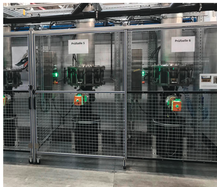
Um den hohen Qualitätsstandard zu gewährleisten, werden die Absperrklappen unter härtesten Bedingungen in einem Prüfstand getestet.
