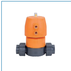
隔膜阀 DIASTAR 10 • ABS, PVC-U, PVC-C, PP-H, PP-N, PVDF, PVDF-HP • EPDM, FKM, PTFE/EPDM, PTFE/FKM • DN15 - DN50 • PN10 • 气动 FC, FO, DA • 可供附件
