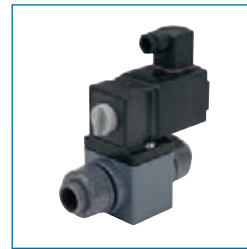
电磁阀 160/161 型 • 直动枢轴电枢阀 • 两位两通或两位三通 • PVC-U • EPDM, FKM • 230 V AC, 24 V AC, 24 V DC • DN10-DN20 • 0-3bar, 取决于尺寸
