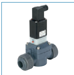
电磁阀 165 型 • 先导辅助电磁阀 • 两位两通 • PVC-U, PVDF • EPDM, FKM • 230 V AC, 110 V AC, 24 V AC, 24 V DC • DN15 - DN50 • 0.5 - 6 bar
