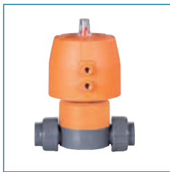
隔膜阀 DIASTAR 10PLUS • ABS, PVC-U, PVC-C, PP-H, PVDF, PVDF-HP • EPDM, FKM, PTFE/EPDM, PTFE/FKM • DN15 - DN50 • PN10（双侧） • 气动 FC, FO, DA • 可供附件
