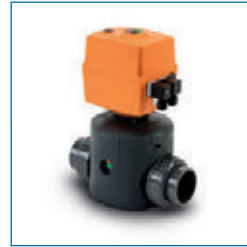
eDiastar – 514 型（螺纹承插口） 和 515 型（插口） • PVC-U, PVC-C, ABS, PP-H, PVDF 可改装: PVDF-HP • EPDM, PTFE/EPDM, NBR, FKM, PTFE/FKM • d32/DN25 和 d63/DN50 • DN25: PN10 / DN50: PN6 • 电动 FC
