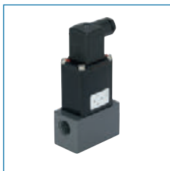
电磁阀 157 型 • 直动枢轴电枢阀 • 两位两通 • PVC-U • EPDM, FKM • 230 V AC, 24 V AC, 24 V DC • DN4-DN8 • 0-4bar, 取决于尺寸
