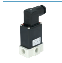
电磁阀 166 型 • 直动枢轴电枢阀 • 两位两通或两位三通 • PVDF • EPDM, FKM • 230 V AC, 110 V AC, 24 V AC, 24 V DC • DN3 - DN5 • 0-10bar, 取决于尺寸
