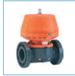
隔膜阀 DIASTAR 025 • ABS, PVC-U, PVC-C, PP-H, PVDF, PVDF-HP • EPDM, FKM, PTFE/EPDM, PTFE/FKM • DN65 - DN150 • PN10 • 气动 FC, FO, DA • 可供附件
