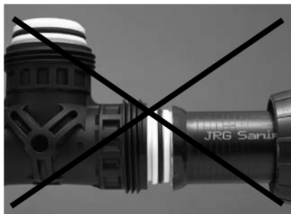
Raccord de serrage incorrectement posé
