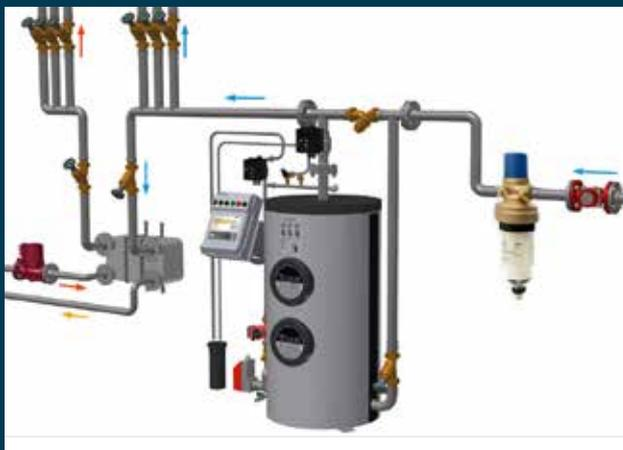
Schematische Darstellung einer Trinkwasser-Installation mit BIOCAT 14000
