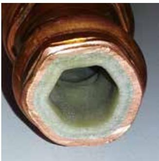
Kupferrohr mit Kalkschicht
