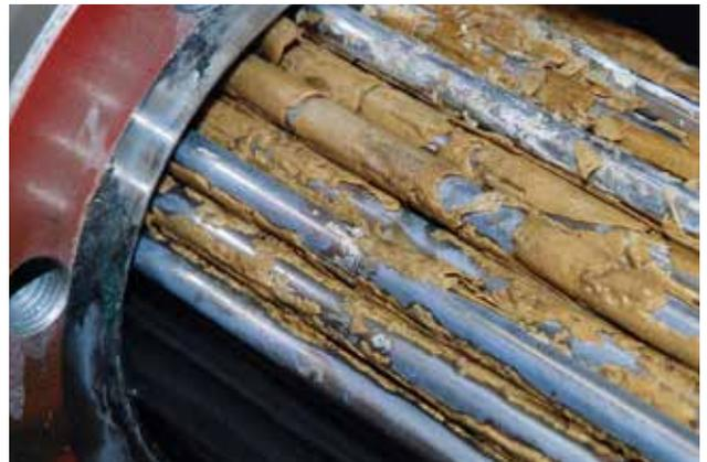
Rohrbündelübertrager mit Kalkablagerungen
