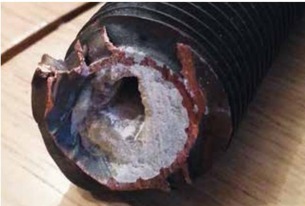
Verkalkter Kupfer-Rippenrohr-Wärmetauscher aus einem Pufferspeicher
