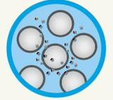
Die gezielte Bildung von kleinsten Kalkkristallen erfolgt in einer elektro-physikalischen Zelle (Behandlungseinheit). Dort wird das Kalk-Kohlensäure-Gleichgewicht in den Bereich starker Kalksättigung geschoben, sodass es im Bereich der Elektroden zur Bildung kleinster Kalkkristalle kommt, die an das vorbeifließende Wasser abgegeben werden.
