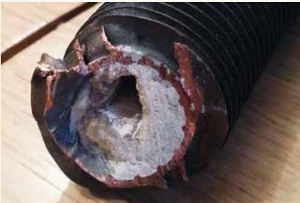
Verkalkter Kupfer-Rippenrohr-Wärmetauscher aus einem Pufferspeicher
