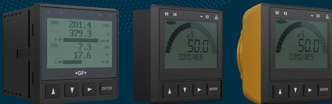
Os transmissores GF estão disponíveis em opções de um, dois e seis canais, podendo ser montados em painel ou em campo. Eles suportam medições de vazão, pH/ORP, condutividade/resistividade, salinidade, temperatura, pressão, nível, oxigênio dissolvido e dispositivos que transmitem um sinal de 4 a 20 mA, com o uso do conversor de canal único 8058 iGo®.
