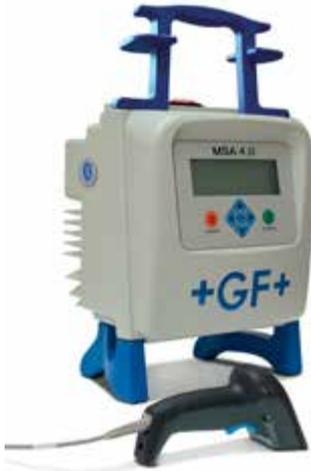
Das automatische Elektroschweisgerät MSA 4.1 verbindet dank der Inverter Technologie niedriges Gewicht mit hoher Leistungsfähigkeit, sowie eine komplette Schweißdokumentation, einschliesslich Bedienerausweis, Auftragsnummer, Produktrückverfolgung von Rohrleitungskomponenten (ISO 12176) und Positionsbestimmung der Schweißverbindung mit eingebautem GPS Empfänger.
