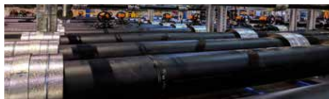
Módulos de tubos pré-fabricados prontos para serem enviados para o canteiro de obras.
