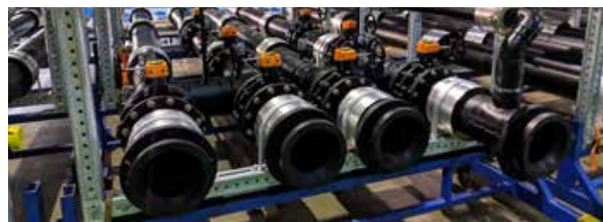
Módulos de tubos pré-fabricados prontos para serem enviados para o canteiro de obras.
