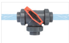
Abgang geschlossen, Durchgang offen mit verringertem Durchfluss
