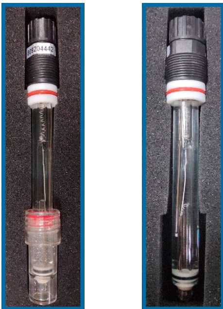
图 2-9 带电极帽的 pH 电极和 pH 电极
