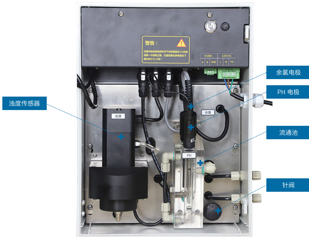
图 2-1 机箱内部结构图
